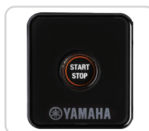
7 - CONTACTEUR START/STOP DOUBLE POSTE/ MONO MOTEUR
